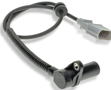
# 60331 CRANKSHAFT (AUDI/VW OE #077-905-381-G/N)
