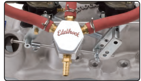
Mini Triple Fuel Block #1286 installed
