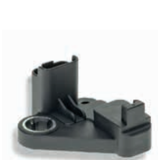
60473 Sensorart / sensor type Kurbelwellensensor / crankshaft sensor Induktiv-Geber / inductive type Verwendung für: / applicable for: FORD LAND ROVER
