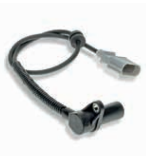
60331 Sensorart / sensor type Kurbelwellensensor / crankshaft sensor Induktiv-Geber / inductive type Verwendung für: / applicable for: AUDI VW
