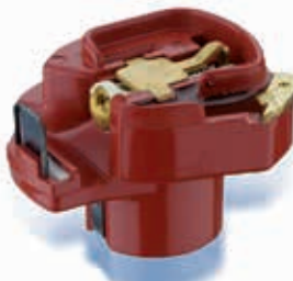
7007 Zündsystem / system Bosch Polyester/Polyester 1000 Ohm entstört/suppressed Max. Drehzahl/RPM: 6350 /min.
