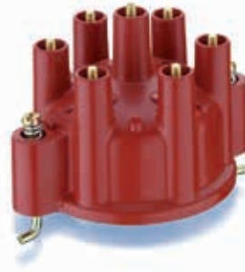
8054 Zündsystem / system Bosch Polyester/Polyester 1000 Ohm entstört/suppressed
