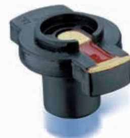
7382 Zündsystem / system Ducellier Polypropylen/Polypropylen 1000 Ohm entstört/suppressed Verwendung für: / applicable for: CITROEN FIAT PEUGEOT
