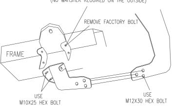
NOTE REMOVE FACTORY BOTTOM PLASTIC BALANCE OR CUT A SLOT IN THE PLASTIC BALNCE TO AITACH
